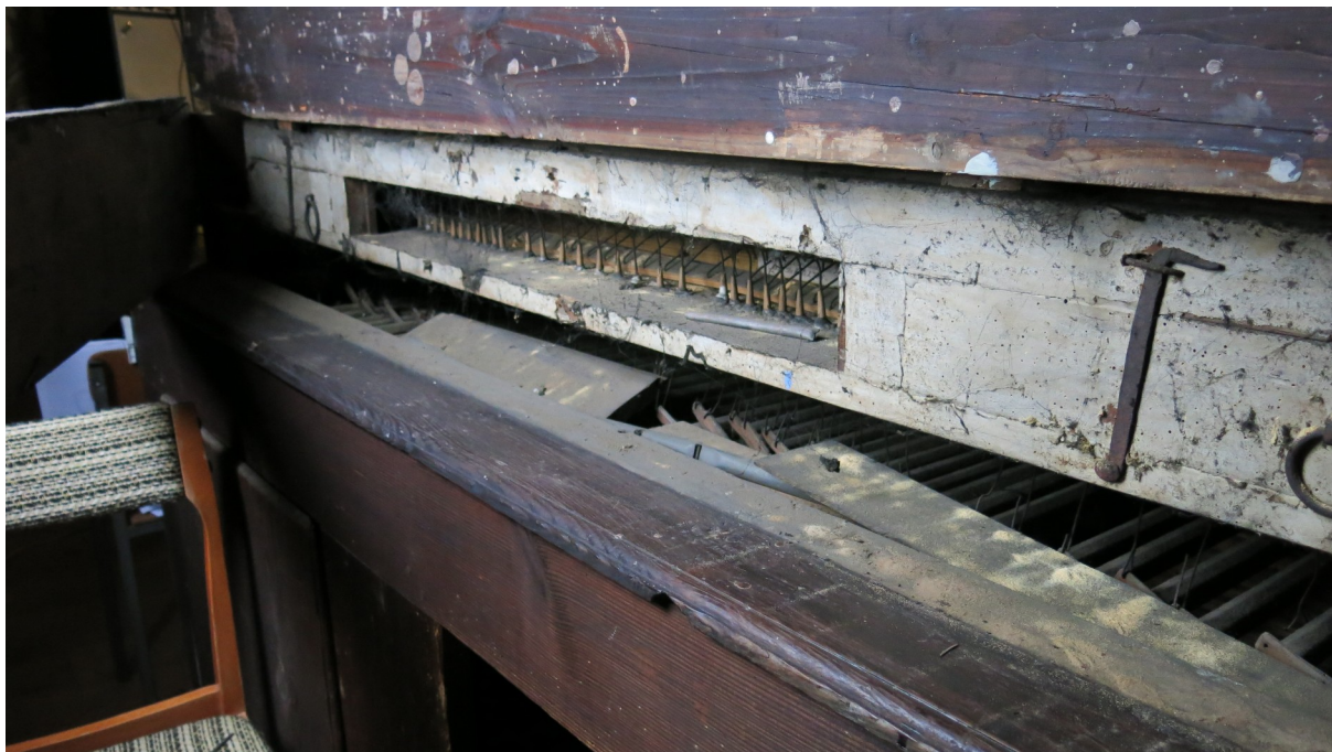
Wiatrownica , zamknięcie komory klap.
